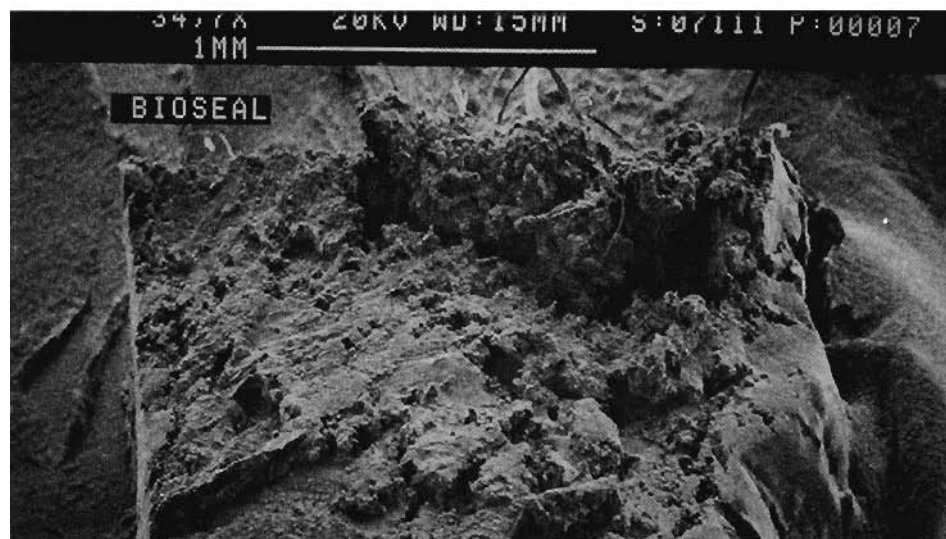
Fig. 16 - Analisi di un terzo cemento. Si rilevano i seguenti componenti: zinco e calcio.
