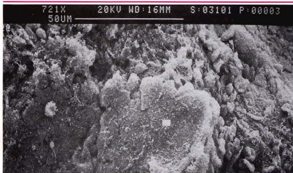
Fig. 11 - Immagine al MES con relativo esame che rileva consistenti depositi di argento e tracce di zinco.
