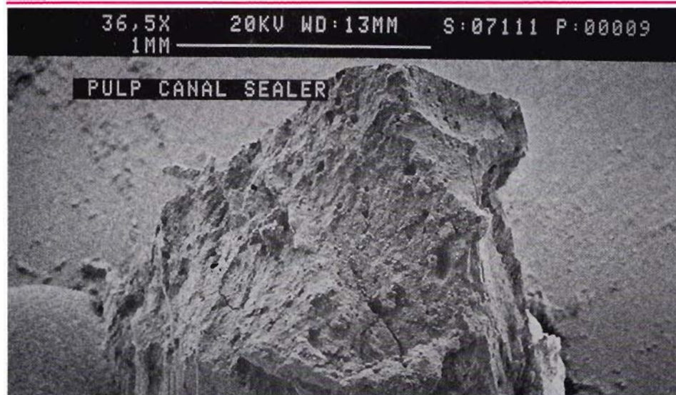
Fig. 14 - Immagine di un campione di cemento analizzato. Si rilevano argento, zinco, iodio.
