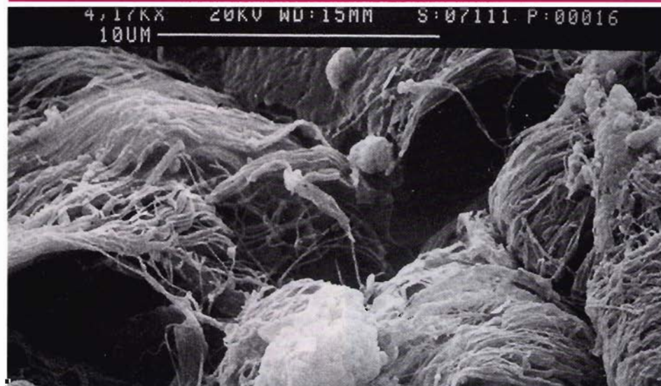
Fig. 13 - Immagine di una particolare zona che si rivela essere costituita prevalentemente da silicio, calcio, cloro e potassio. Il picco più alto è relativo al metallo adoperato (oro) per il rivestimento del campione da osservare al MES.
