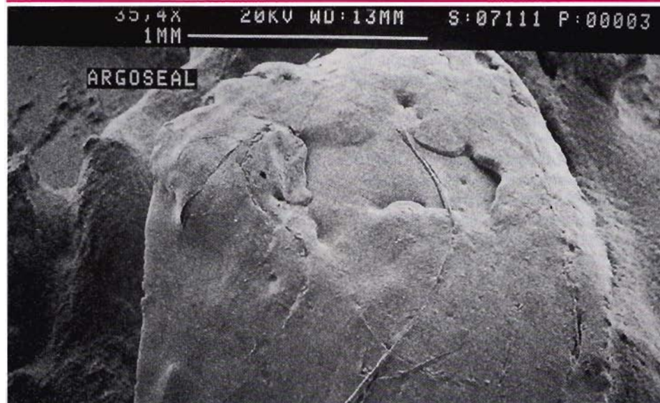
Fig. 15 - Particolare di un secondo cemento analizzato. Si rileva la presenza di argento, zinco, silice, iodio.
